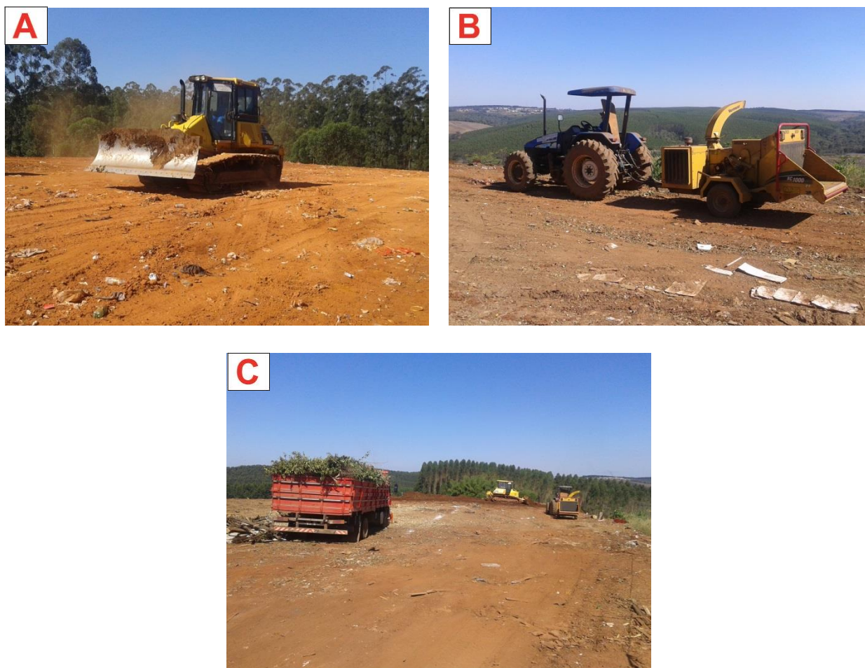
Figura 142: Trator esteira (A), picador de resíduos verdes (B) e caminhão coletor de resíduos verdes (C).
